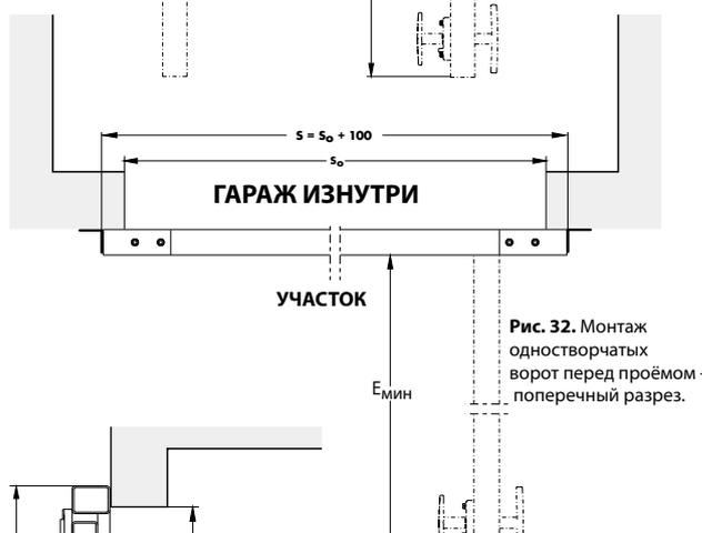
Рис. 32. Монтаж одностворчатых ворот перед проёмом - поперечный разрез.
