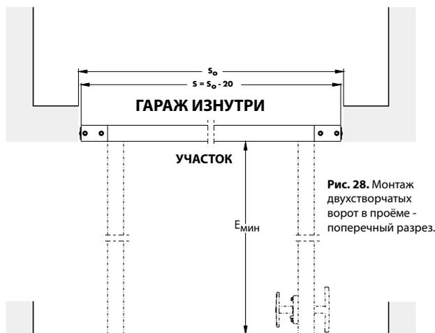
Рис. 28. Монтаж двухстворчатых ворот в проёме - поперечный разрез.
