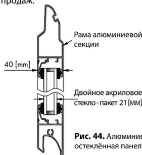
Рис. 44. Алюминиевая остеклённая панель - разрез.
