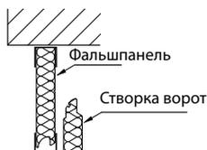
Рис. 15. Фальшпанель выполнена из стальной панели, заполненной пенкой.
