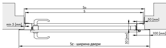
Рис. 20. Монтаж в проёме - вертикальный разрез.
