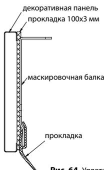
Рис. 64. Уплотнение RenoSystem - маскировочная балка.
