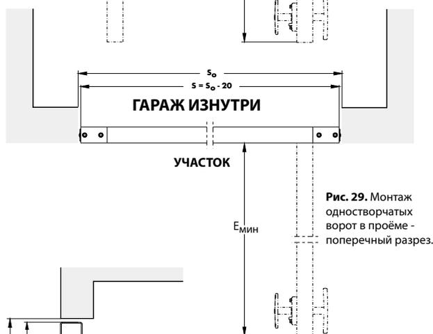
Рис. 29. Монтаж одностворчатых ворот в проёме - поперечный разрез.
