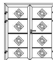
**AP-7** - горизонтальные декоративные элементы из нержавеющей стали устанавливаются на формировках и соединениях на нижней и центральной панели. На верхней панели - только для формировки W.
