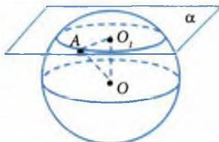
$\alpha$  — секущая плоскость,  $OO_1 \perp \alpha \Rightarrow O_1$  — центр круга, являющегося сечением данного шара плоскостью  $\alpha$ ;  $OA = R$  — радиус шара.
