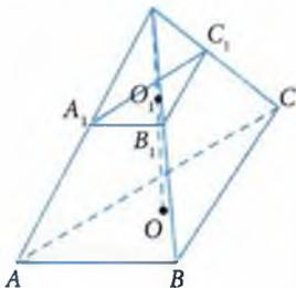
$$V = \frac{1}{3} (S_{\Delta ABC} + S_{\Delta A_1 B_1 C_1} + \sqrt{S_{\Delta ABC} \cdot S_{\Delta A_1 B_1 C_1}}) \cdot OO_1$$
