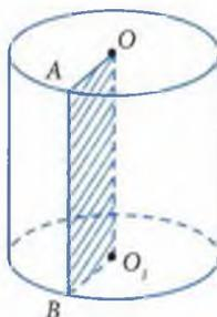
$OO_1$  — ось цилиндра. Стороны  $AO$  и  $BO_1$  описывают равные круги, лежащие в параллельных плоскостях, их называют **основаниями** цилиндра.
