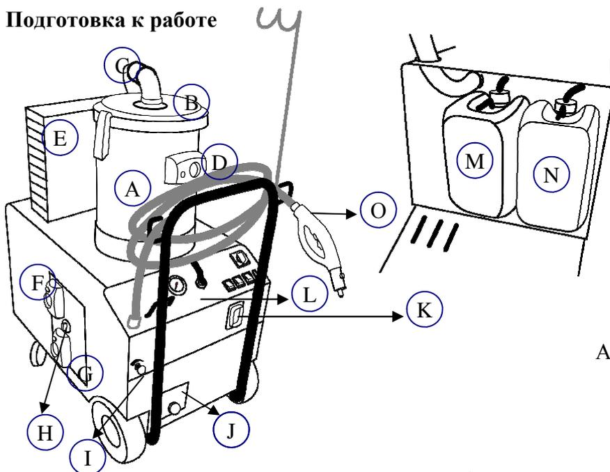
A – стальной мусоросборник для аспирации твердых частиц и жидкости
