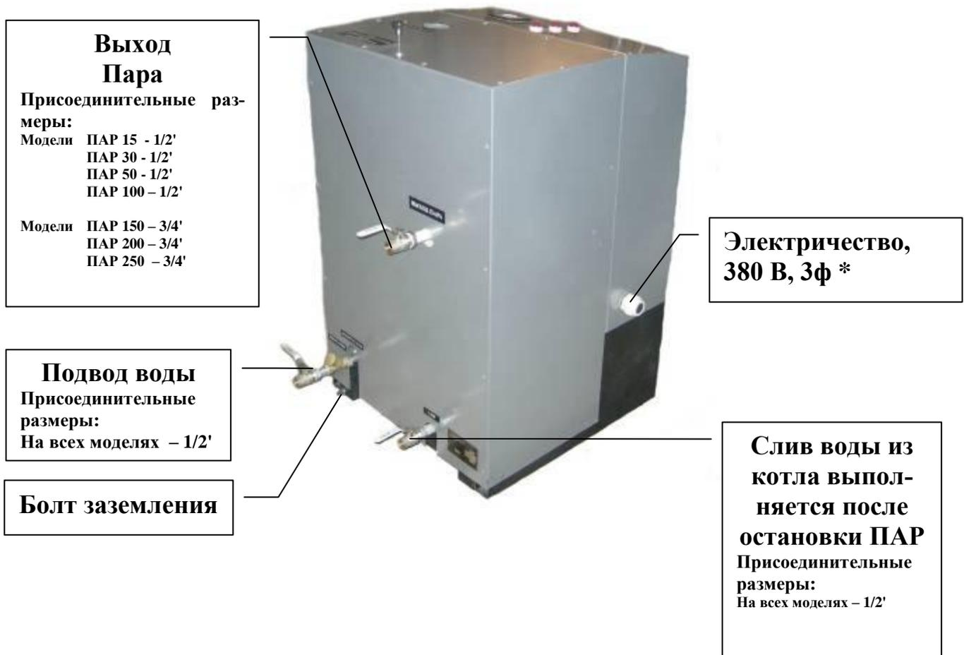
\* В зависимости от производительности парогенератора, подбирается кабель сечением от 1 мм<sup>2</sup> до 185 мм<sup>2</sup> (см. табл. 3)
