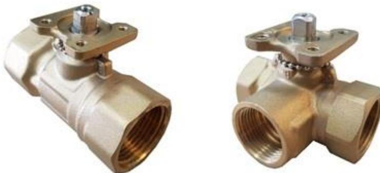
Шаровые краны TECHNO имеют отличную надежность, долгий срок службы и высокую герметизацию благодаря литому корпусу из латуни с применением фторопластовых уплотнений (PTFE), шара и вала из нержавеющей стали, двум уплотнительным кольцам из этиленпропиленового каучука (EPDM) для стержня крана, корректирующему диску, обеспечивающему равнопроцентную характеристику потока.
