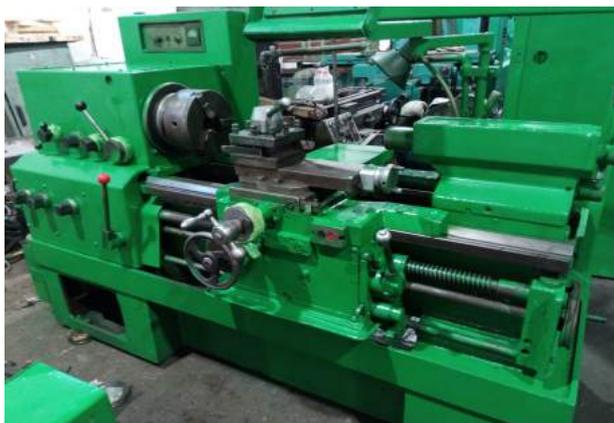
Станок токарно-винторезный 16к20
