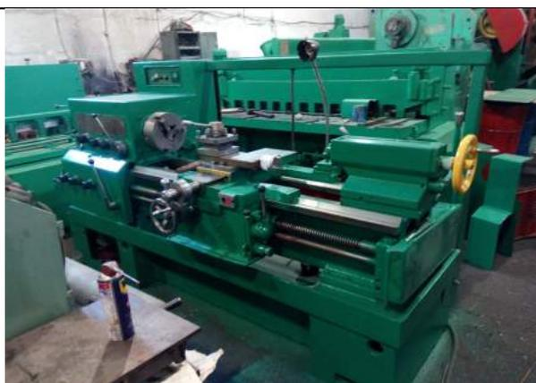
Станок токарно-винторезный 16к20
