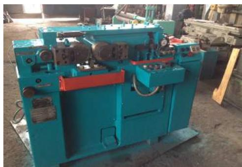
Полуавтомат профиленакатный двухроликовый А9518А резьбонакатной
