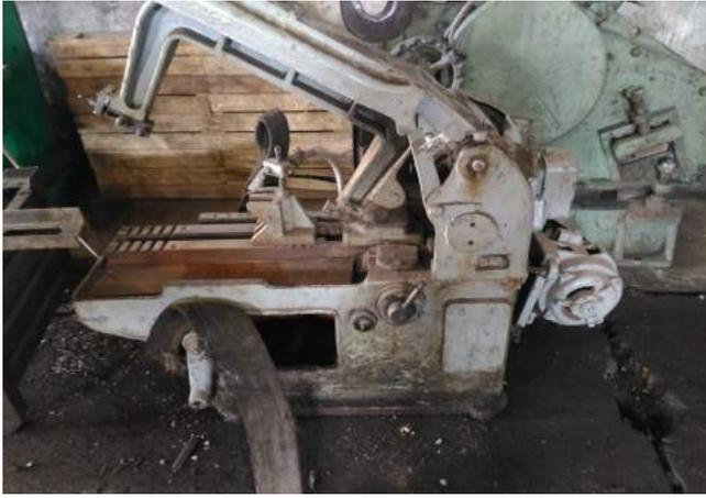
Станок ножовочно-отрезной 8720
