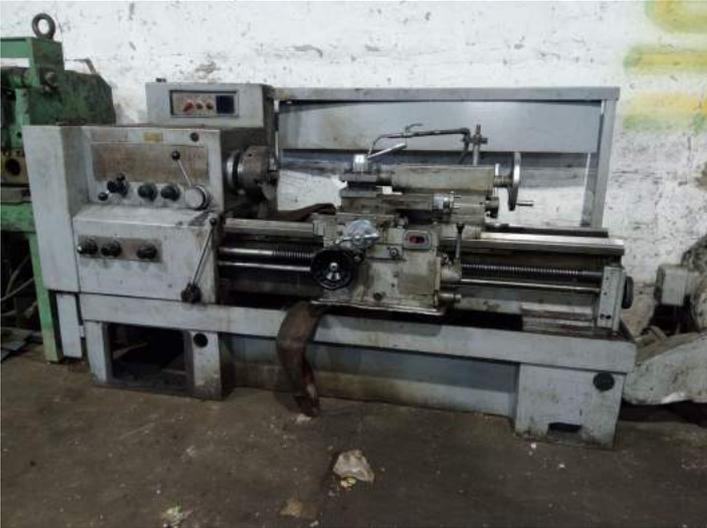
Станок токарно-винторезный 16к20
