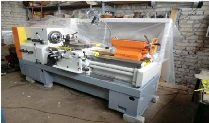
Токарно-винторезный 16К20 кап.ремонт и модернизация 2016 год Красный Пролетарий рмц-1000 мм , гарантия А также 1К62 и 1В62Г и другие аналогичные модели с рмц 750-1200 мм также есть 1к62, 1в62г и другие
