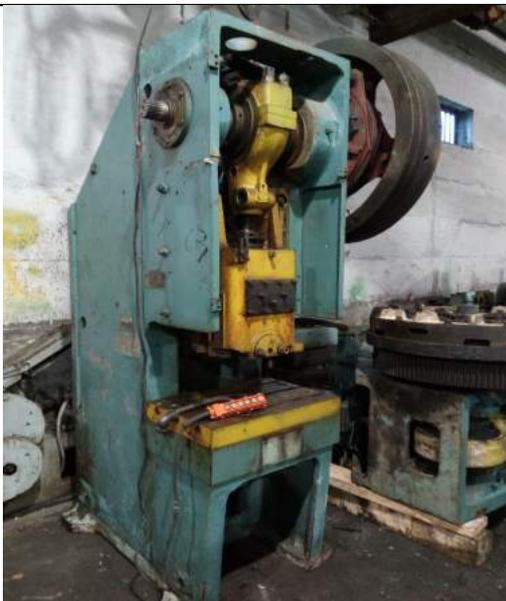
Пресс кривошипный КД2128 1989 год в хорошем рабочем состоянии , нет электрощкафа
