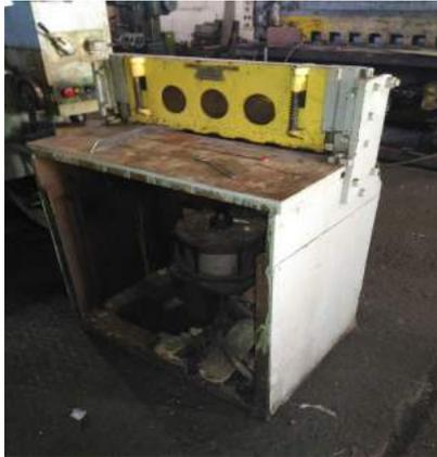
**Ножницы пневматические 2\*750 мм
