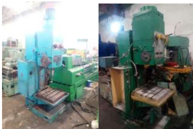
Станок вертикально-сверлильный 2Н135 В ремонте
