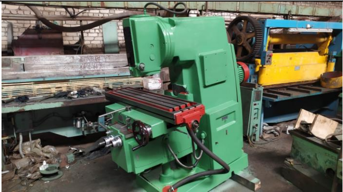
Станок вертикально-фрезерный 6P12 после ремонта В наличии 2 шт
