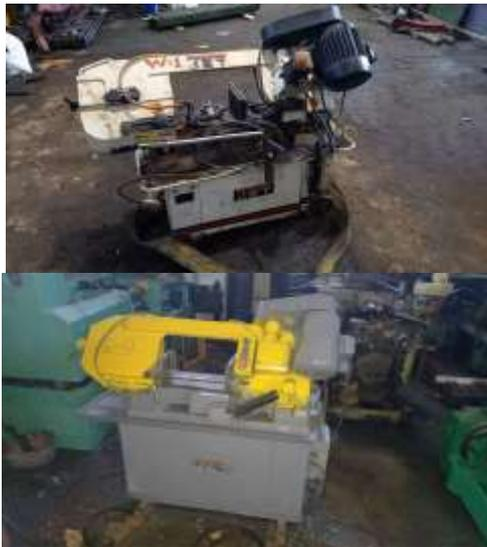
Станок ленточнопильный Jet712
