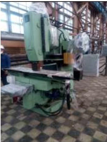
Станок фрезерный с ЧПУ
