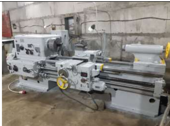
Станок токарно-винторезный 1М63МФ101 рмц 1500 бу после проведения ППР В НАЛИЧИИ
