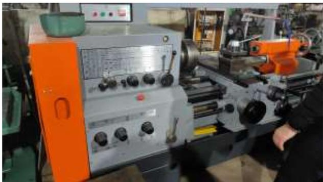
Станок токарно-винторезный МК6056 в хорошем рабочем состоянии после среднего ремонта
