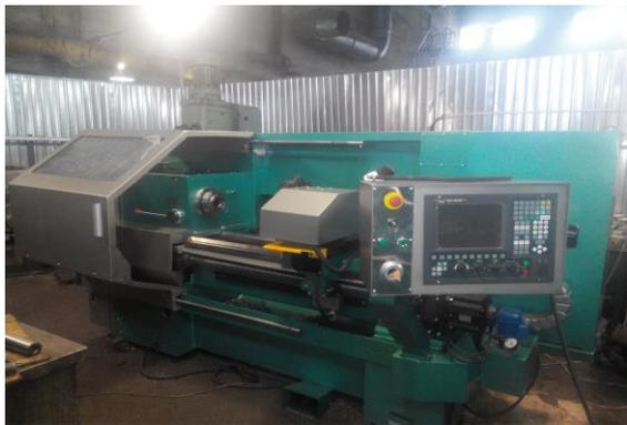
Станок токарно-винторезные с ЧПУ
