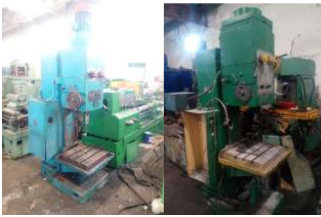
Станок вертикально-сверлильный 2Н135 В ремонте
