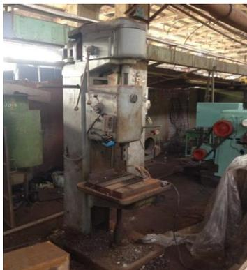
**Вертикально-сверлильный 2a125 бу в нормальном рабочем состоянии с проверкой в работе**
