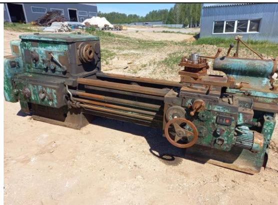
Станок токарно-винторезный 1м63 рмц1500 под восстановление
