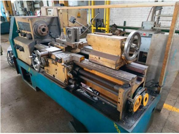
Станок токарно-винторезный 1B62Г рмц
