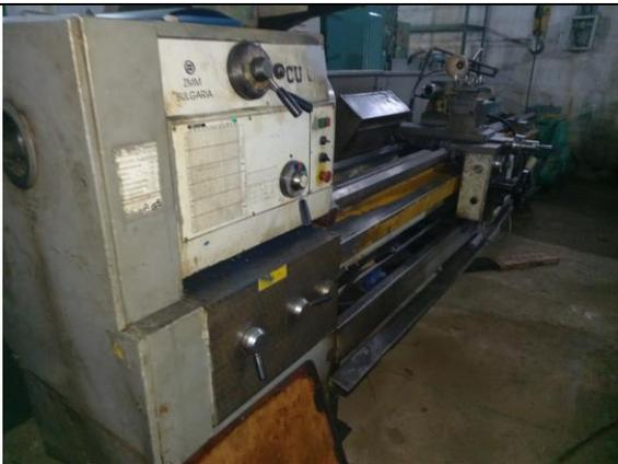
Станок токарно-винторезный CU630\*3000
