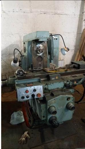
Станок горизонтально-фрезерный с ВГФ
