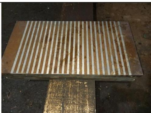
Плита магнитная 630\*320мм
