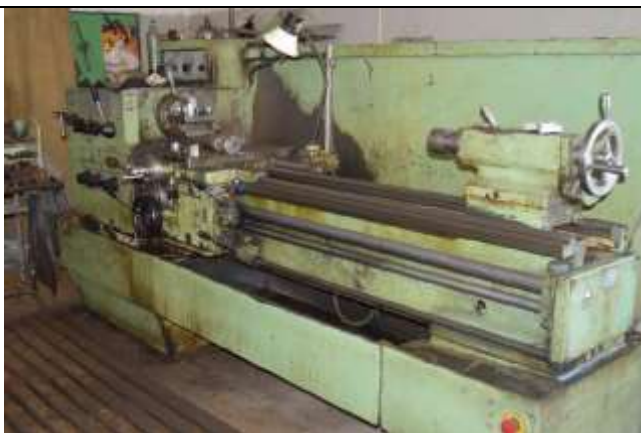
Токарно-винторезный Samat400 / 1500 В РЕМОНТЕ
