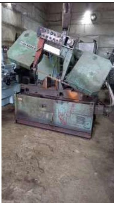
Станок ленточнопильный автомат
