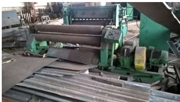
Вальцы листогибочные И2220 В ремонте
