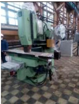
Станок фрезерный с ЧПУ
