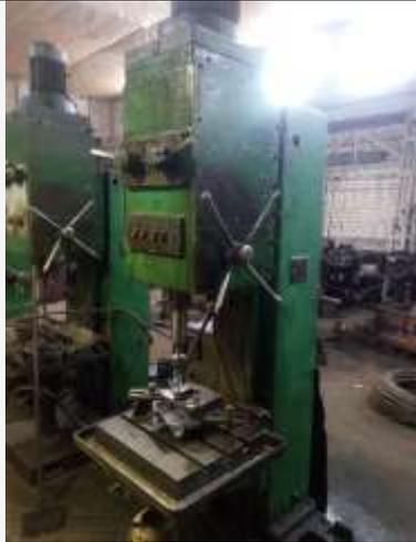
Станок вертикально-сверлильный 2N135
