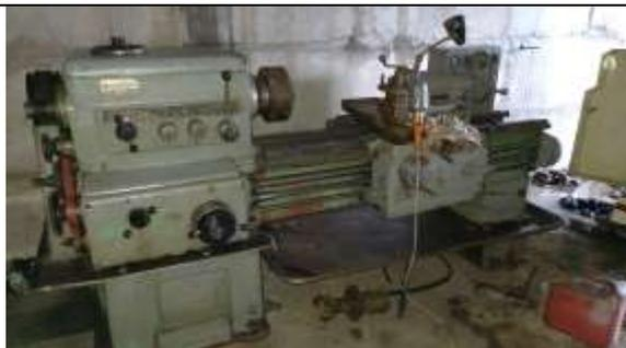
Станок токарно-винторезный 1K625 рмц 1000
