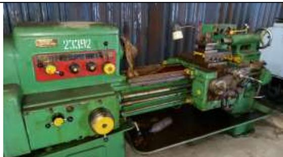
Станок токарно-винторезный 1K625 рмц 1000
