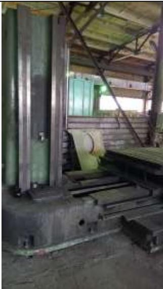
**Станок горизонтально-расточной W100
