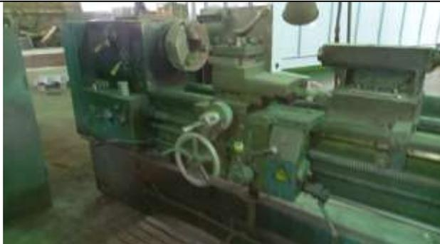
**Станок токарно-винторезный CU580 рмц
