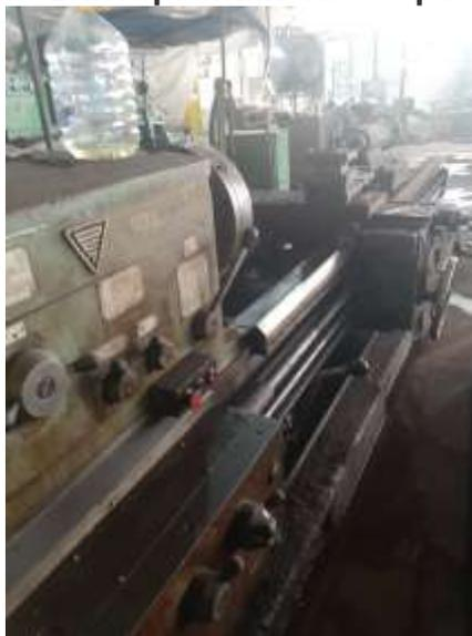
Токарно-винторезный станок мод. 1М63БФ101 предназначен для выполнения разнообразных токарных работ, включая точение конусов и нарезание резьб: метрических, дюймовых, модульных, питчевых. Высокая мощность привода и жесткость станка, широкий диапазон частоты вращения шпинделя и подачи позволяют полностью использовать возможности прогрессивных инструментов при обработке различных материалов.
