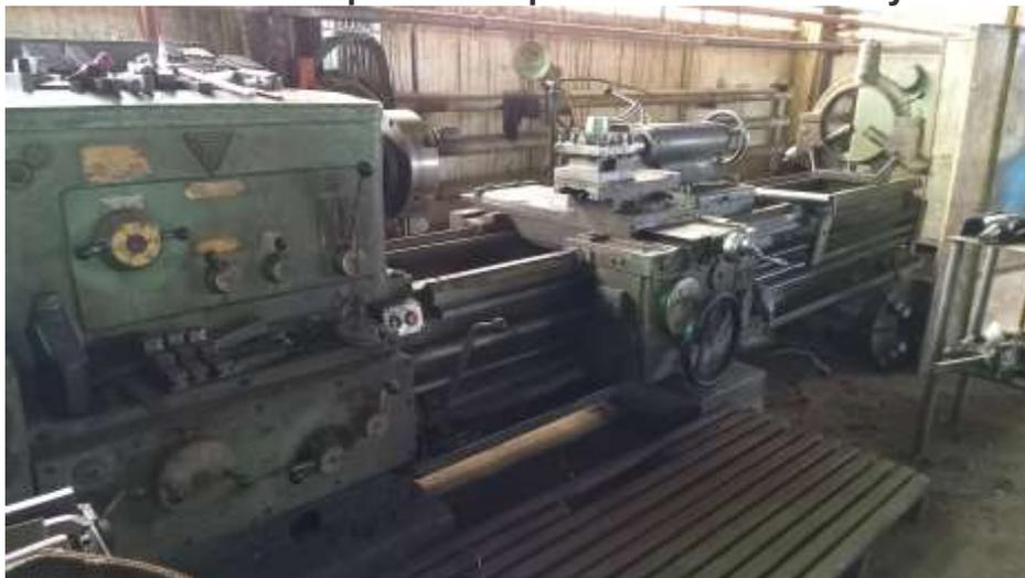
Токарно-винторезный станок мод. 1М63 предназначен для выполнения разнообразных токарных работ, включая точение конусов и нарезание резьб: метрических, дюймовых, модульных, питчевых.
