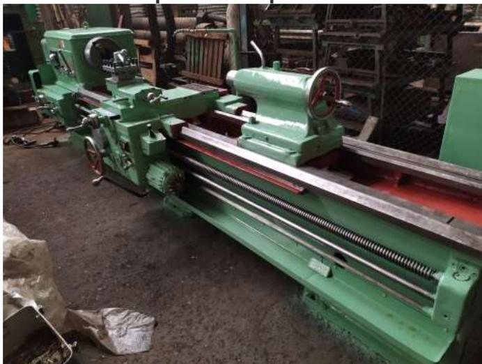
Токарно-винторезный станок мод. 1М63 предназначен для выполнения разнообразных токарных работ, включая точение конусов и нарезание резьб: метрических, дюймовых, модульных, питчевых.
