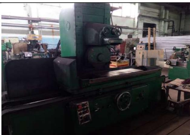
Станок плоскошлифовальный 3Б722
