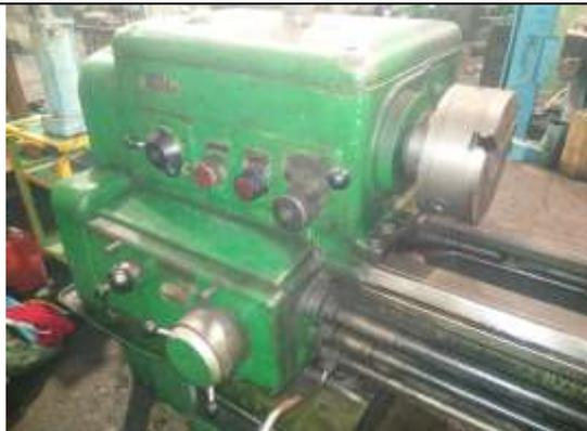
Станок токарно-винторезный 1K62
