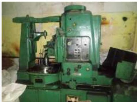
**Станок зубофрезерный 5e32**
