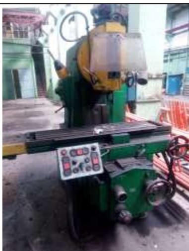
**Станок вертикально-фрезерный 6т12-1
