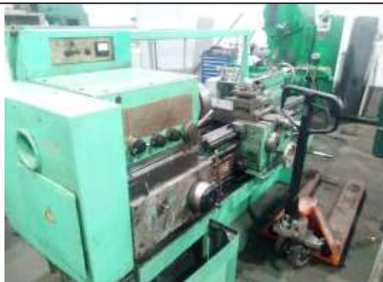
Станок токарно-винторезный 1K62Д б/у
