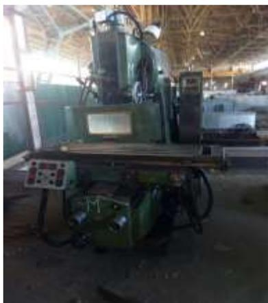
Станок вертикально-фрезерный 6T12Ф20
