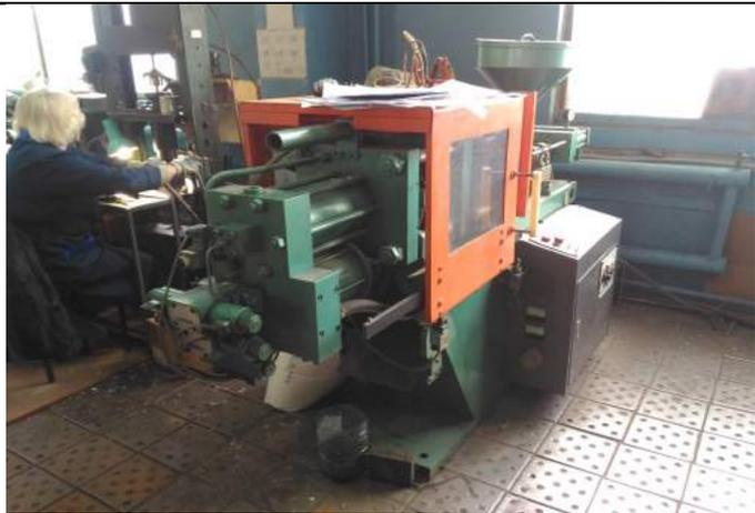
Термопластавтомат MJ20D Китай 1991 год в отличном состоянии до 20см3
