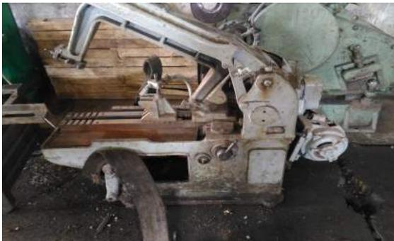
Станок ножовочно-отрезной 8720
