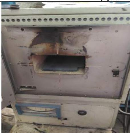
Печь муфельная закалочная 1200С камера 100\*200\*400 мм
