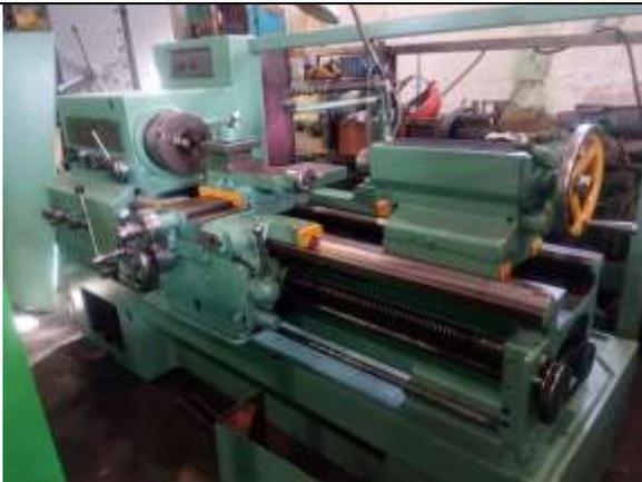
Станок токарно-винторезный 16к20
