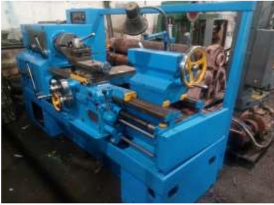
Станок токарно-винторезный 16к25
