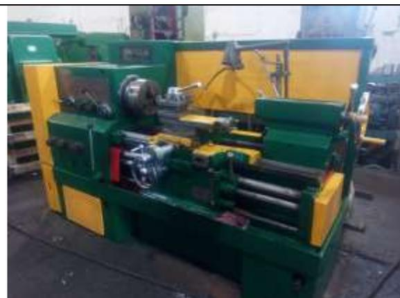
Станок токарно-винторезный 16к20
