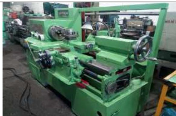
Станок токарно-винторезный 16к20
