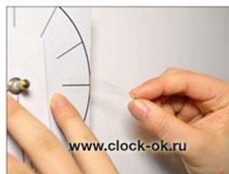
Установить шаблон на часовой механизм и закрепить квадратную (не подвижную) часть шаблона на часовом механизме (использовать канцелярский скотч)
