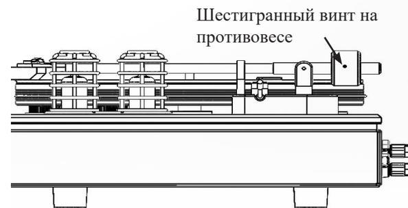
Рисунок 06 - Регулировка противовеса
