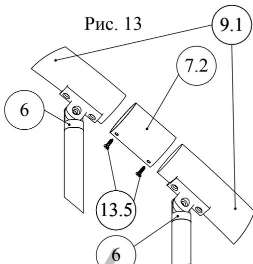
6.13 Элементы поручня (9.1) стыковать между собой при помощи соединителя (7.2), который требуется закрепить саморезами 16 (13.5). Данную последовательность действий повторить до верха лестницы. Окончание верхнего элемента поручня отпилить пилой-ножовкой.
