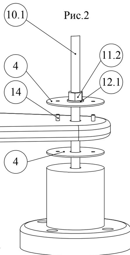
6.2 Надеть на штангу (10.1) поочерёдно детали, как указано на рис.2. Ступень (1.1) притянуть к бочонку (2.1) с помощью гайки с шайбой (11.2+12.1).
