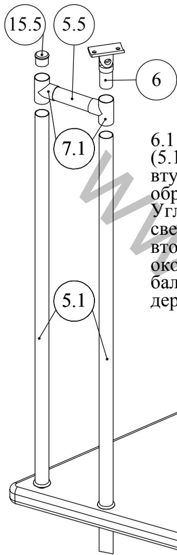
6.11 Соединить две балясины (5.1) на углу площадки (1.2) втулкой (5.5), используя Т-образные соединители (6). Угловую балясину закрыть сверху заглушкой (15.5). Во вторую балясину, являющуюся окончанием спиральной балястрады, вставить держатель поручня (6).
