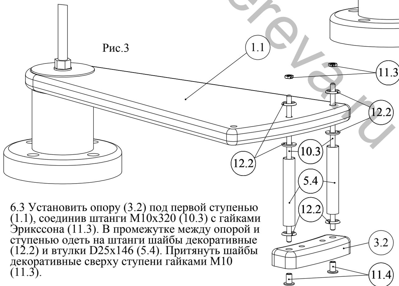
6.3 Установить опору (3.2) под первой ступенью (1.1), соединив штанги M10x320 (10.3) с гайками Эрикссона (11.3). В промежутке между опорой и ступенью одеть на штанги шайбы декоративные (12.2) и втулки D25x146 (5.4). Притянуть шайбы декоративные сверху ступени гайками M10 (11.3).
