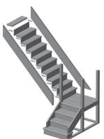
8. Устанавливают столб 920 мм (поз. 26) на верхнем этаже. На первую ступень крепят два столба 1100 мм с пазом под нижнюю струну (поз. 25). Отдельно собирают и потом крепят между столбами конструкции поручней с балясинами и основанием. Верхняя часть – длиной 2700 мм (9 балясин, угол 44 град., поз 29, 32, 35), средняя прямая часть – 740 мм (3 балясины, поз. 28, 31, 34), две нижних части – по 820 мм (по 3 балясины, угол 34, поз. 27, 30, 33)
