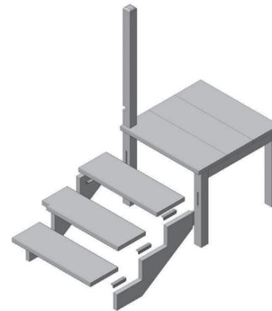
4. К боковым столбам(поз. 1 и 3) в пазы крепят верхние струны(поз. 12). В верхней части струны скрепляют стяжкой(поз. 13) с помощью саморезов 3,5x70 мм. Лестницу устанавливают в месте использования и надежно крепят к перекрытиям и стенам помещения(крепёж в комплект поставки не входит).
