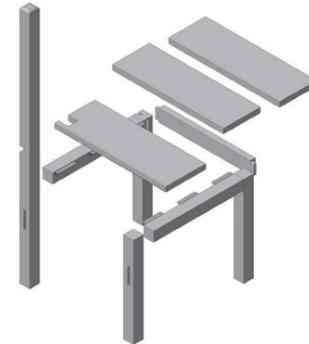
2. Сверху на полученное основание крепят три элемента, образующих площадку(поз. 7 и 8). Элементы закрепляются к обвязке снизу с помощью металлических уголков и саморезов 3,5x35 мм.
