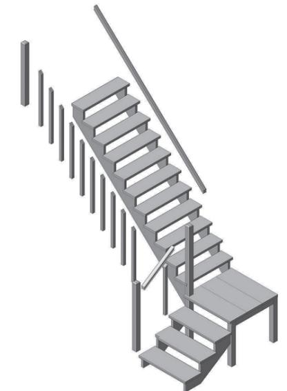
7. После установки и осадки лестницы весь крепёж затягивают окончательно.
