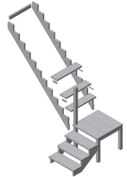
5. На струны последовательно крепят верхние ступени (поз. 14, 11 шт.) с помощью уголков.
