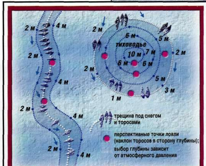
Рис. 3. Определение рельефа дна по торосам.
