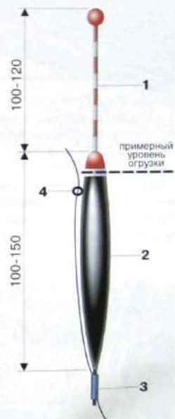
1. Конструкция поплавка для ловли с дальним отпуском: 1 – антенна; 2 – тело поплавка; 3 – киль с кембриком; 4 – пропускное кольцо.
