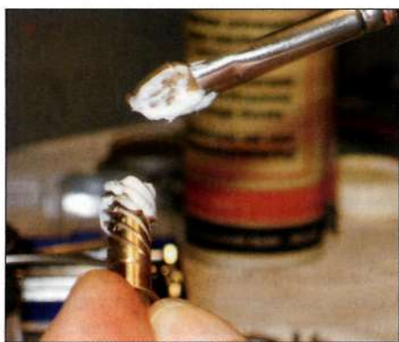
9. Шестеренки и втулки очищают и затем смазывают.
