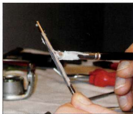
11. Смазывают шток шпули, используя тонкую кисточку**.
