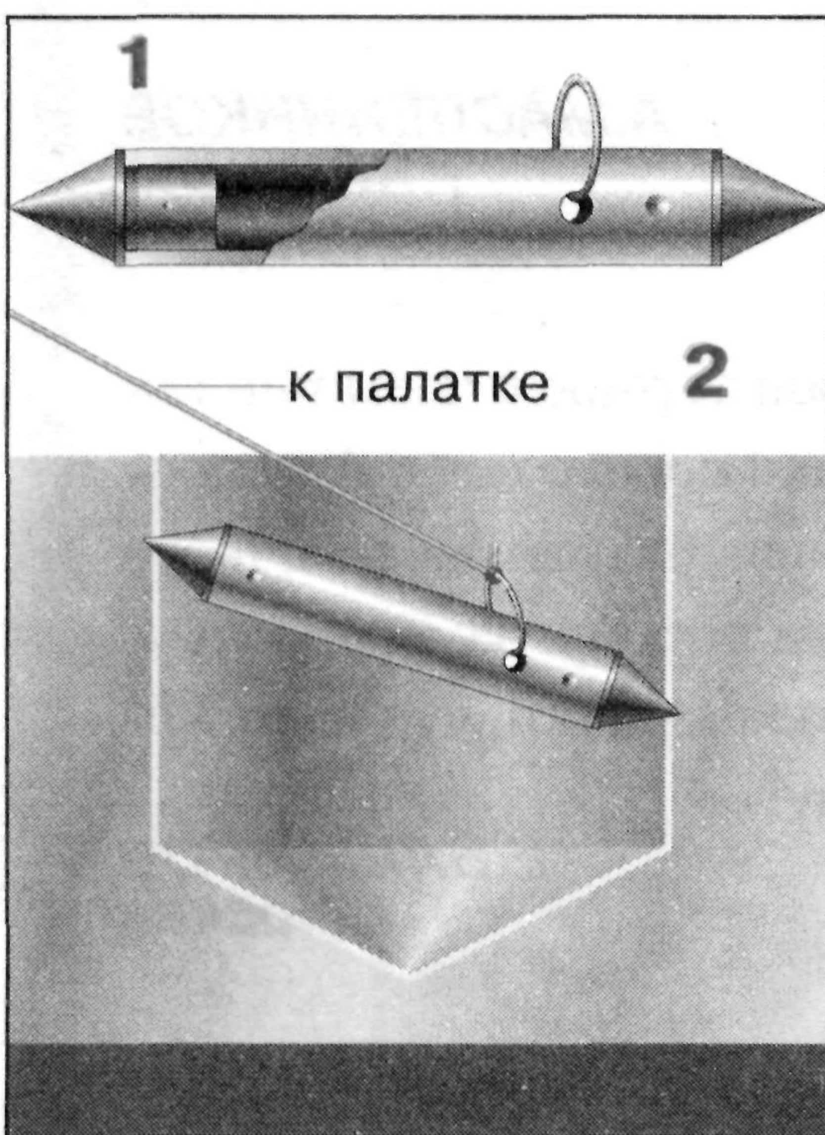
Беру заостренный с обеих сторон штырек, длина которого на 10-15 мм больше, чем диаметр ледобура. Штырьки изготавливаю из отрезков лыжных палок. Впрессовываю с обеих сторон стальные наконечники (рис.1).
