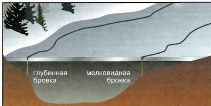
2. Образование первичных трещин в местах стыковки льда с различной толщиной.
