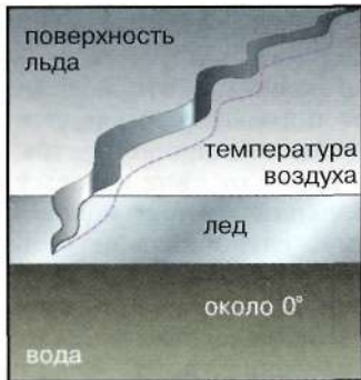
1. Разлом на поверхности льда, вызванный его температурной деформацией.
