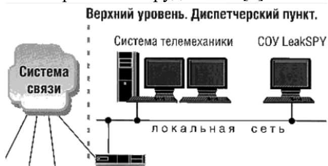
Рисунок 1 – Структура системы обнаружения утечек «LeakSPY»
