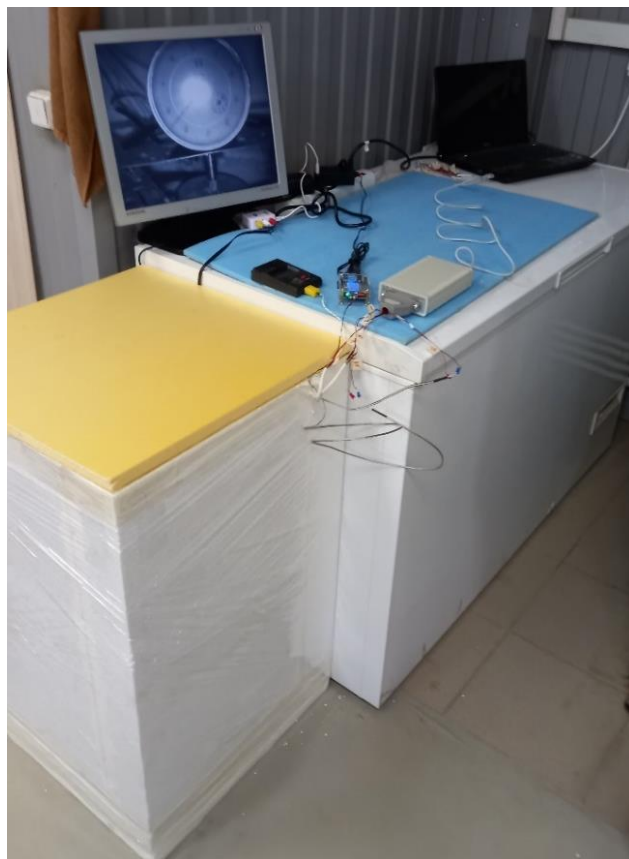
Рис. 2. – Стенд для изучения температурных полей при выдерживании в термосе
