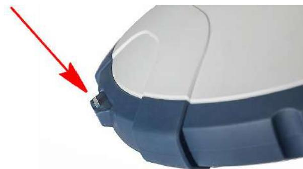
Когда приемник устанавливается на штатив, например, в качестве базовой станции, часто наклонное измерение высоты инструмента бывает удобнее, чем вертикальное от исходной точки до относимой (проецируемой) точки антенны.
