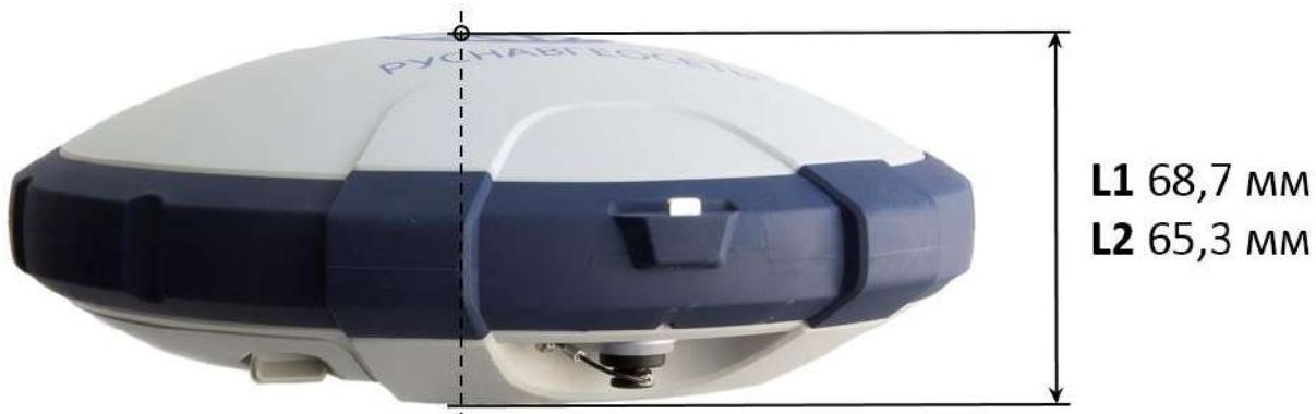
Полевое ПО обычно использует в расчетах реальную высоту инструмента, основанной на расположении фазового центра на частоте L1.
