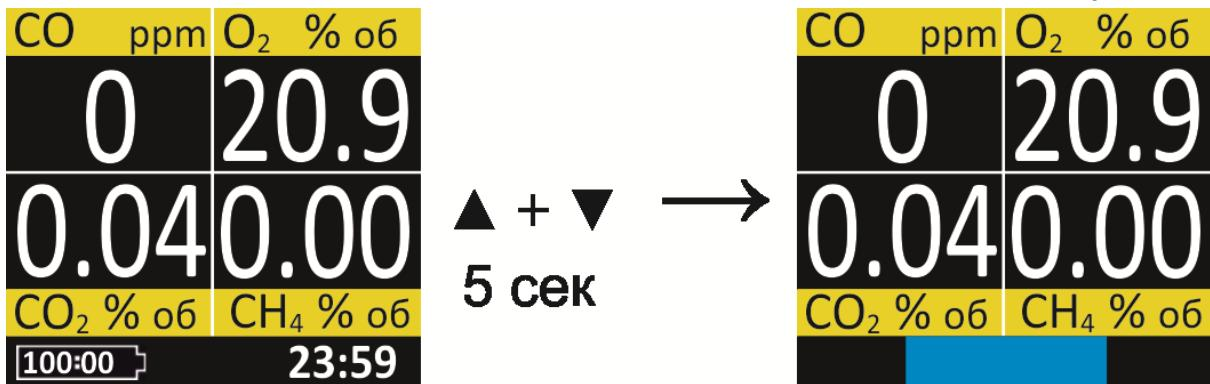
Рисунок 4. Снятие блокировки дисплея
