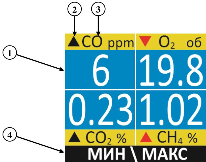
Рисунок 12. Дисплей в режиме отображения
