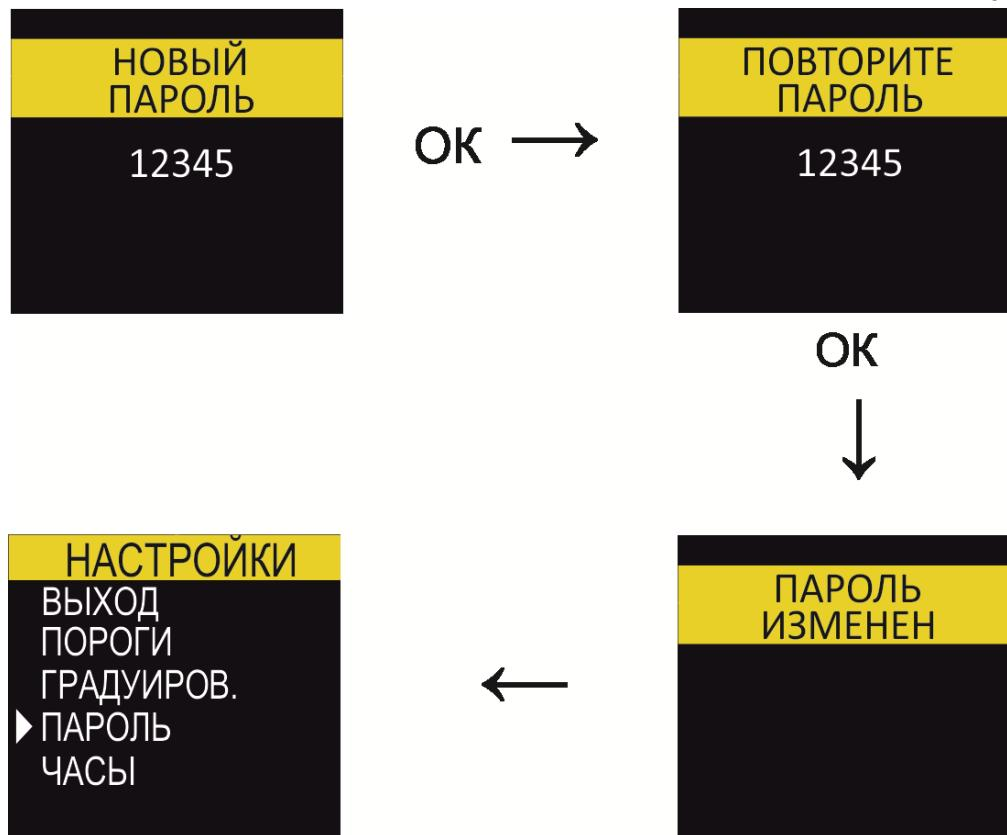
Рисунок 10. Дисплей в режиме "ПАРОЛЬ"
