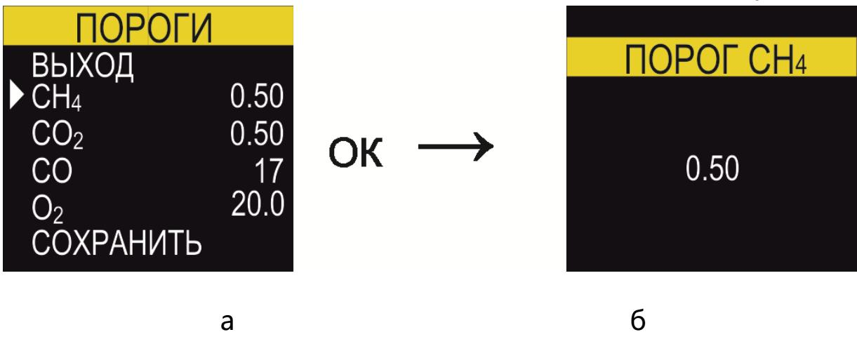
Рисунок 9. Дисплей в режиме "ПОРОГИ" (пример для настройки порога канала CH<sub>4</sub>)
