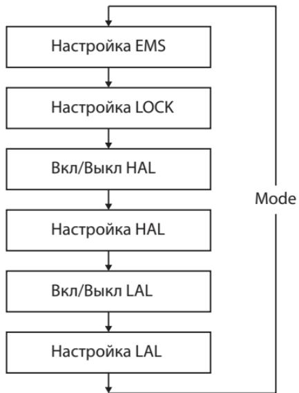
На экране прибора отображается текущая измеренная температура до очередного нажатия рычага спускового механизма. В режиме блокировки нажать кнопку «Вверх» или «Вниз» для настройки коэффициента излучения, включения или выключения режимов HAL, LAL.
