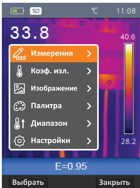
**Измерения:** настройка для расчетов и отображения радиометрических данных измерения температуры, которые касаются снимков.
