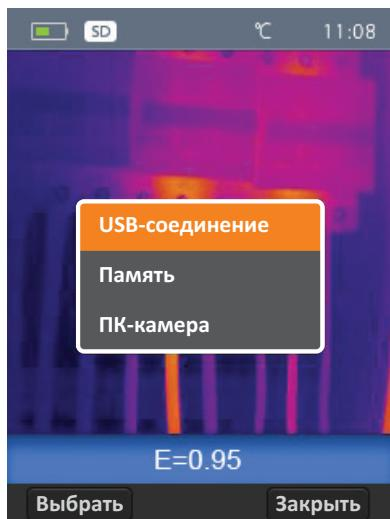
Имеется два режима работы с USB: память и ПК-камера. Нажать кнопку «Вверх» или «Вниз» для выбора режима.
