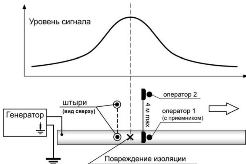
Рисунок 5.2.2 – Схема подключения и уровень сигнала при поиске повреждения изоляции по увеличению сигнала
