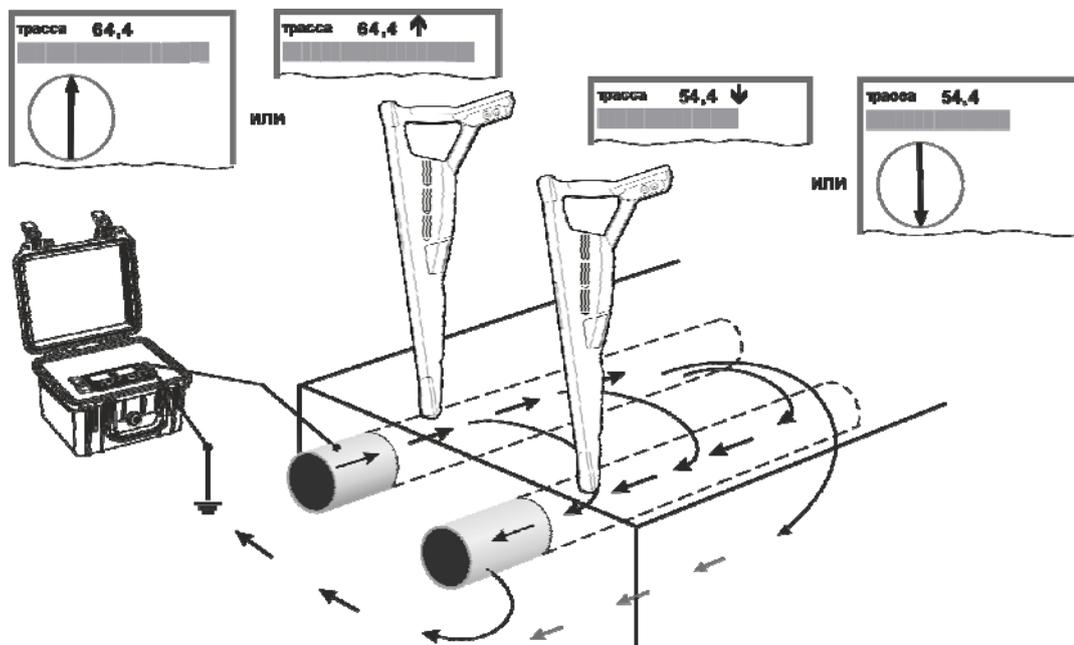
Рисунок 4.2.4.1 – Направление тока в соседней, гальванически развязанной коммуникации
