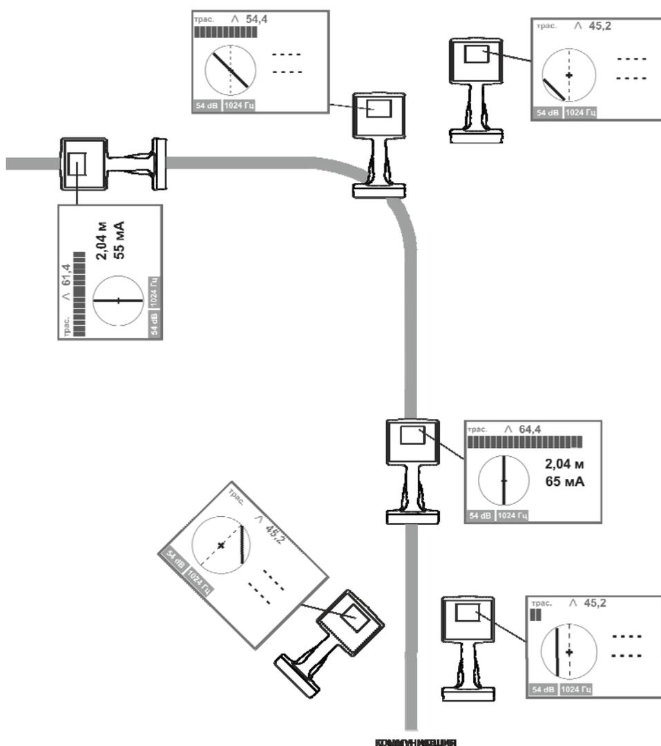
Рисунок 4.2.3 – Поиск с включенной функцией «КОМПАС»
