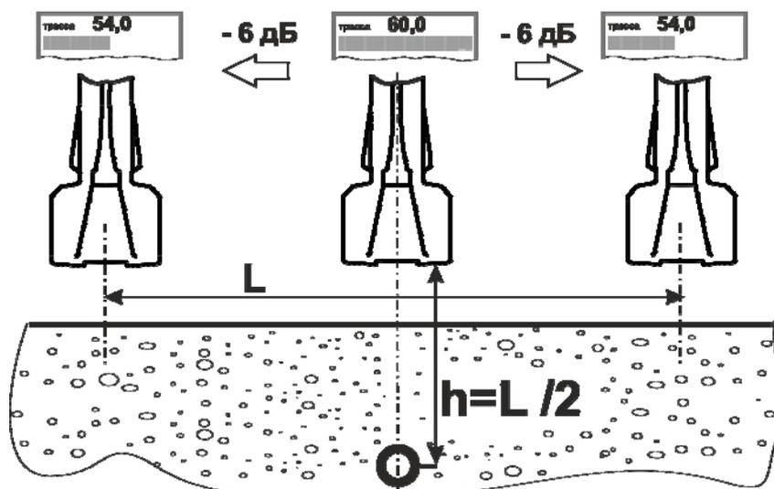
Рисунок 4.3.1 – Определение глубины залегания методом «-6дБ»
