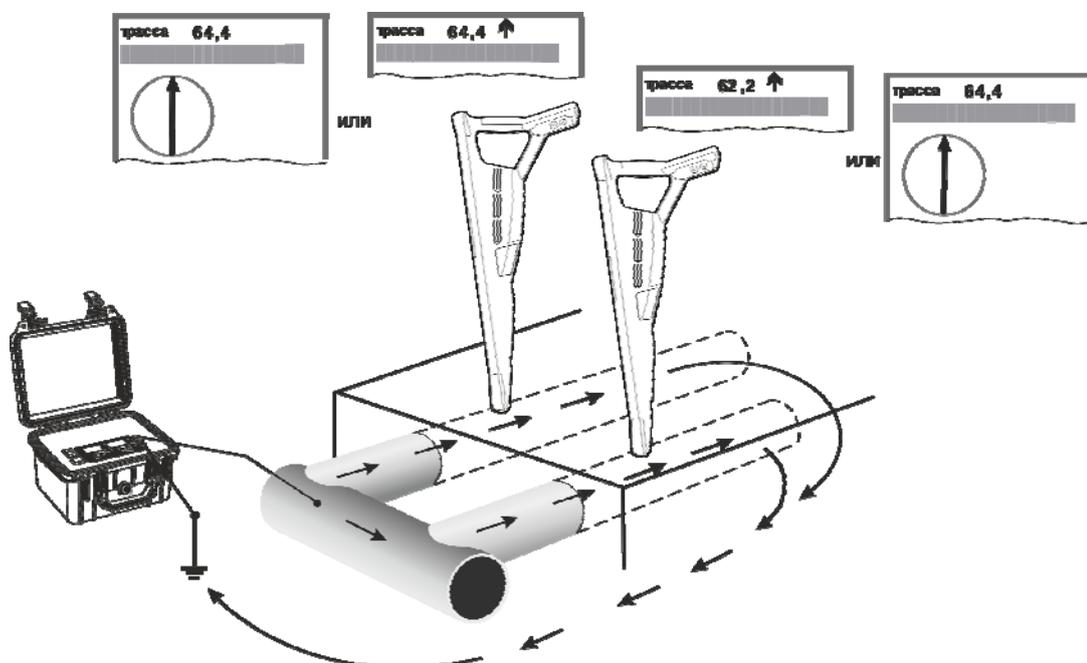
Рисунок 4.2.4.2 – Направление тока в гальванически связанных коммуникациях
