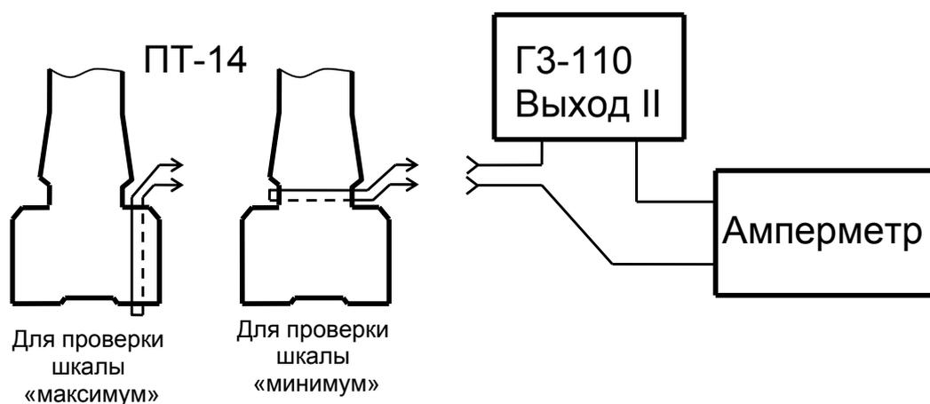
Рисунок 13.5.3 – Схема рабочего места для проверки чувствительности
