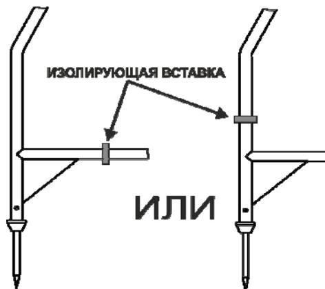
В отличие от датчика ДКИ-02 применение датчика «А-рамка» позволяет точнее определять уровень сигнала от измерения к измерению, т. к. фиксированное расстояние между штырями исключает ошибку увеличения/уменьшения уровня сигнала из-за изменения расстояния между ними. Однако применение датчика требует заглубления в грунт штырей, что не всегда возможно.
