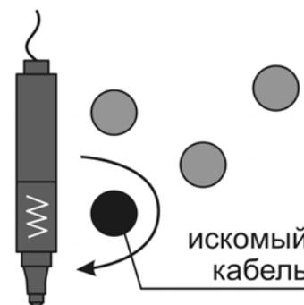
Рисунок 5.4.1 – Поиск кабеля (жилы) по максимуму сигнала
