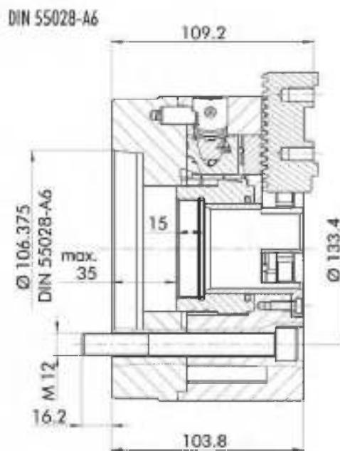
Futter für Wellenspannung in geöffneter Stellung dargestellt
