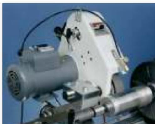
Машина для шлифовки валов с электроприводом
