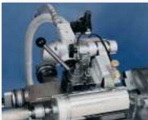
Машина для шлифовки валов с пневмоприводом
