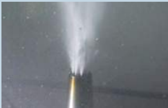
Cool Flash – effektive Kühlung an den Schneiden Cool Flash – эффективное охлаждение режущей кромки
