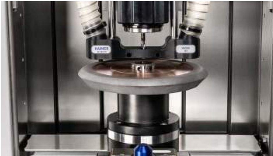
Auswuchten einer Schleifscheibe durch axiales Bohren
