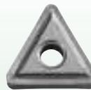
Двусторонняя пластина с положительной геометрией. Заданный угол наклона снижает усилия резания и обеспечивает хорошее стружкодробление в широком диапазоне подач.
