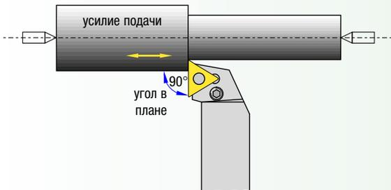
Державки с углом в плане 90° обычно рекомендуются для обработки нежестких заготовок, зажимаемых в центрах.
