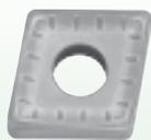
Высокая стабильность режущей кромки позволяет вести обработку с образованием стружки наибольшего сечения и с максимальным удельным съемом металла. Для обработки в условиях прерывистого резания и выполнения операций с высокой нагрузкой на режущую кромку. Глубина резания до 16,0 мм и подача до 1,6 мм.
