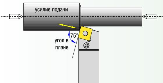
Державки с углом в плане 75° рекомендуются для обработки жестких заготовок и для выполнения операций с незначительными прерываниями.
