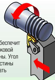
Высота режущей кромки является постоянной величиной в любой комбинации режущей и опорной пластин. Все державки поставляются с опорной пластиной с углом наклона 1-1,5°.
