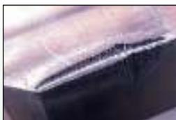
1. Обрабатываемый материал налипает на поверхность вершины пластины, приводя к мгновенному отрыванию фрагментов поверхности пластины.
