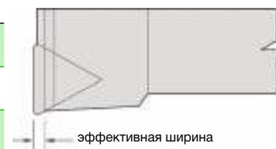
\*\*Для стружколомания как на главной, так и на вспомогательной режущих кромках.
