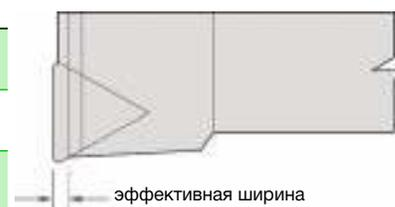
\*\*Для стружколомания как на главной, так и на вспомогательной режущих кромках.
