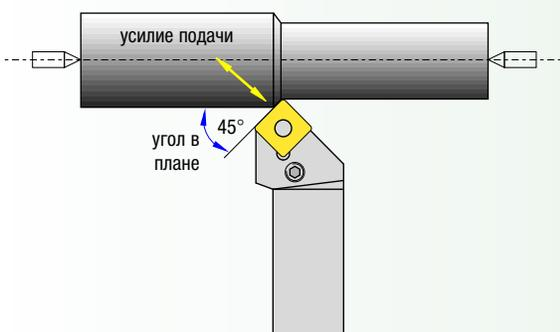
Державки с углом в плане 45° рекомендуются для черновой обработки и снятия фасок в условиях прерывистого резания.
