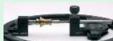
Удерживает цилиндрическую деталь между крепежными наконечниками.
