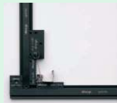
Зубчатая линейка позволяет проходить свету. Пружинный фланец фиксирует деталь в позиции, необходимой для измерения.
