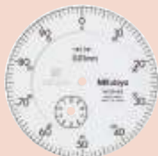
Непрерывная шкала (Двунаправленная градуировка)
