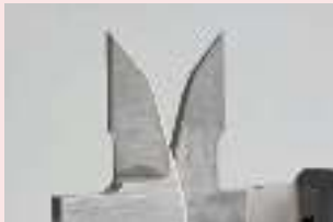
Губки с твердосплавными измерительными поверхностями
