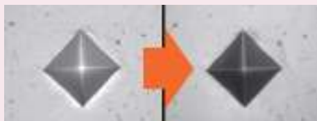
Наблюдаемое изображение отпечатка (50X) Снижение рассеянного света вокруг отпечатка
