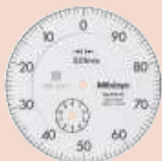
Непрерывная шкала (реверсивное считывание показаний)
