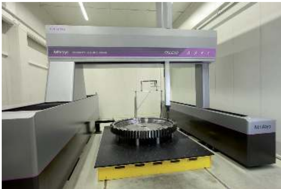
Измерение шестерни ветродвигателя на FALCIO-Арех 305020 G
