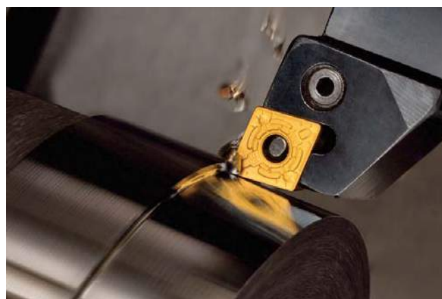
Токарная обработка с большой подачей при высокой скорости резания при использовании стружколома NGE (Сплав с покрытием: AC810P)
