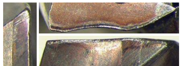
Состояние режущей кромки после 66,4 м сверления
