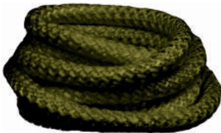
Базальтовый уплотнительный шнур служит для уплотнения и герметизации при монтаже вентиляционных систем. Производится из базальтовых нитей, которые, в свою очередь, сделаны из горной породы базальт. Шнуры толщиной 8 мм и более производятся с сердечником. Сердечник состоит из пучков более тонких нитей.
