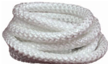
Огнестойкий уплотнительный кремнеземный шнур является отличным огнезащитным и теплоизоляционным материалом. Производится из кремнеземных нитей, которые более чем на 95% состоят из диоксида кремния. По сути, это обычный песок, из расплава которого производят нити. Кремнеземные шнуры обладают высокими огнестойкими и теплоизоляционными свойствами, а также применяются для электроизоляции. Состоят из оплетки и сердечника из кремнеземных нитей.
