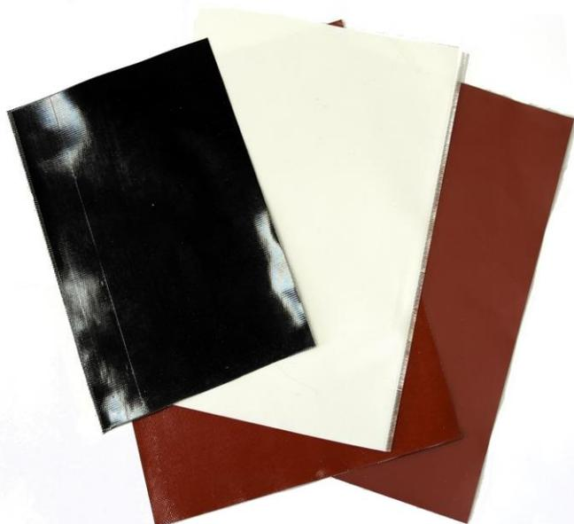
В качестве материала основы для стекловолоконной ткани с покрытием из кремнийорганического каучука компания «**Эксимпак Оборудование**» использует стекловолокно с последующей пропиткой и покрытием одной или обеих сторон специально компаундированным кремнийорганическим каучуком для усиления прочности, огнестойкости, термоизоляции при высоких температурах, обеспечения возможности эксплуатации изделия с озонем, кислородом, маслом, а также под воздействием солнца и атмосферных явлений.
